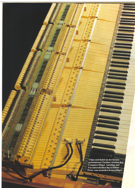
Abbildung 11: Innenleben des MIDI-Computerflügel Bösendorfer 290-SE
